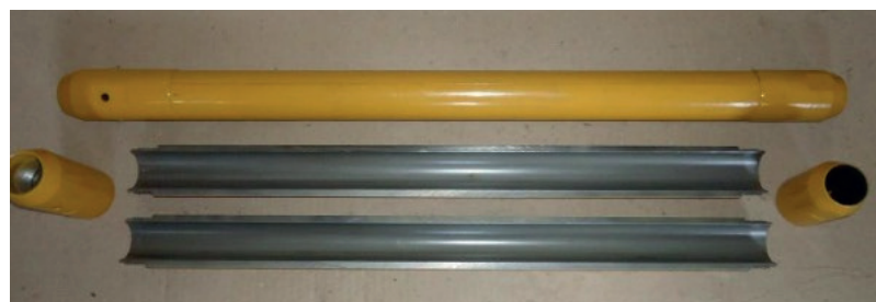
Figura 4 – Amostrador bi-partido utilizado na sondagem SPT – conjunto completo.
